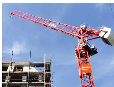
Der Ausleger des WOLFF 166 B lässt sich fast senkrecht aufstellen. Sowohl während der Arbeitszeiten als auch außer Betrieb besteht somit keine Kollisionsgefahr mit Nachbarkranen.
